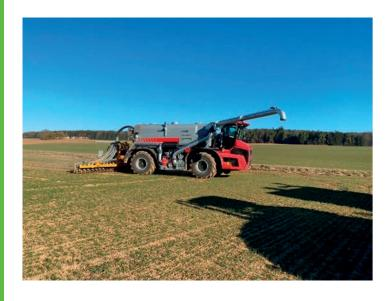
Wie angekündigt, wurde in der Gülle-GbR Seubersdorf der Holmertrac durch ein Neugerät ersetzt. Dieses kann mit einer Scheibenegge, Schlitzgerät aber auch einem Scheibeninjektor eingesetzt werden. Für weite Feld-Hofentfernungen stehen, neben den zwei stan-
